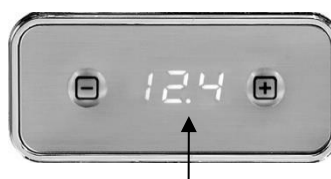
Temperaturanzeige Dampfkessel (t2, hier 124°C) - Punkt an zweiter Stelle
