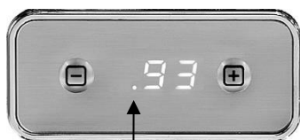
Temperatuur koffie boiler (t1, hier 93°C) -Komma in de 1e positie.
